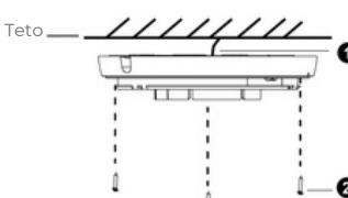
6.5 Conecte todos os cabos e os proteja contra o contato com a água. Alinhe as marcações de instalação. Encaixe a base na carcaça. Rotacione até fixar.
