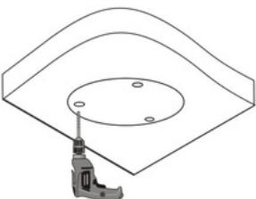
6.2 Coloque os cabos para fora do teto. Monte as buchas plásticas dos parafusos autorroscantes. Coloque as buchas nos orifícios e certifique-se de que estão bem apertadas.
