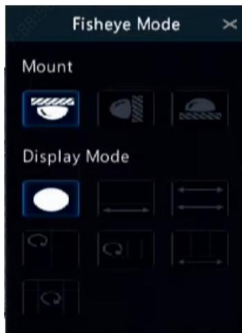
São disponibilizados três modos de montagem: teto, parede, mesa. Os modos de montagem no teto e em mesa usam o mesmo método de eliminação de distorção.
