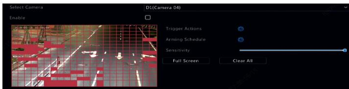
4. Configure a gravação de detecção de movimento: clique em
