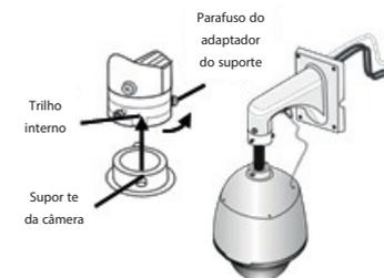
**6.4 Prenda a cúpula com dois parafusos M5 até que fiquem em contato com o tubo metálico.** Após, conecte os cabos e fixe o suporte na parede com arruelas planas, arruelas de pressão e porcas.
