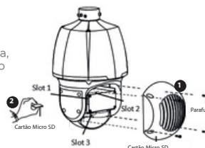
**6.2 Primeiro instale o adaptador no suporte e depois monte a câmera no suporte.** Marque as posições dos furos consultando os pontos de montagem no suporte e passe o cabo pelo furo na parede. Em seguida, monte as buchas plásticas dos parafusos. Gire o adaptador do suporte (rosca macho G1 1/2) e prenda o adaptador do suporte com um parafuso.
