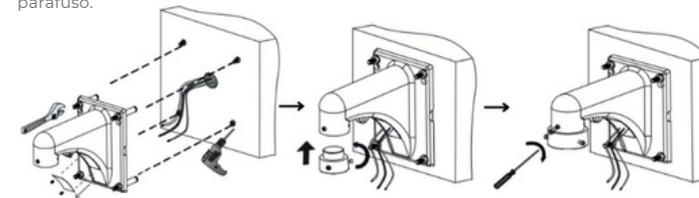
**6.3 Prenda o fio de segurança ao suporte e a cúpula.** Passe o cabo traseiro pelo suporte. Alinhe os dois suportes da câmera na parte superior da câmera com o trilho interno no adaptador do suporte, empurre a câmera para cima e gire a câmera no sentido anti-horário até que ela faça contato com o parafuso do adaptador do suporte.
