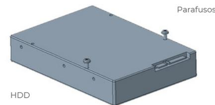
**3. Deslize os parafusos nos furos da parte frontal do chassi de A para B como ilustrado e então parafuse. Aperte os outros dois parafusos para juntar o disco rígido.**
