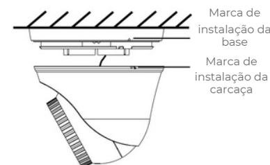
6.6 Ajuste a direção monitoramento. A câmera rotacionar 360° e inclinar 75° de pode
