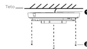
6.5 Conecte todos os cabos e os projeta contra o contato com a água. Alinhe as marcações de instalação. Encaixe a base na carcaça. Rotacione até fixar.
